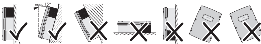
Figure 11 : Positions de montage autorisées et interdites
