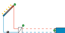
Fonctionnement autonome de l'échangeur de chaleur externe, logique de pompe
