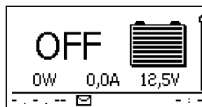
Abb. 4: Display nach dem Einschalten der externen Batteriesicherung
